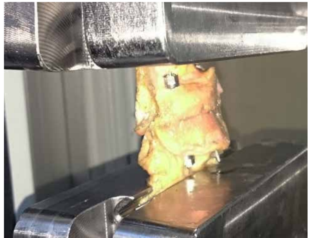
Şekil 5. Gergi bandı ve EFECE sistemleri ile tespit edilen kadvra patella transvers kırık simülasyonlarına artan distraksiyon kuvveti uygulandı.
