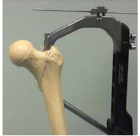
Şekil 3. Yapay kemik üzerine uygulanan çivi ve çakma setine tespitli aparat yandan görünüşü.
