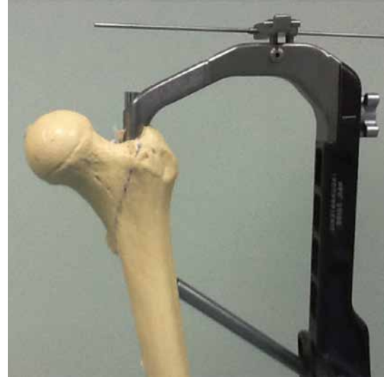
Şekil 3. Yapay kemik üzerine uygulanan çivi ve çakma setine tespitli aparat yandan görünüşü.
