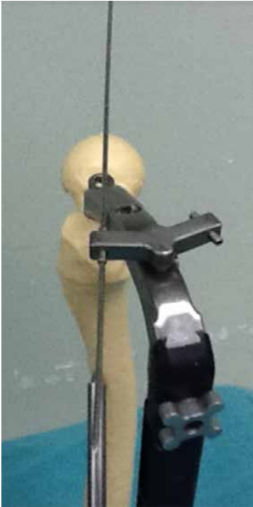
Şekil 4. Yapay kemik üzerine uygulanan çivi ve çakma setine tespitli aparatın üst çaprazdan görünüşü.
