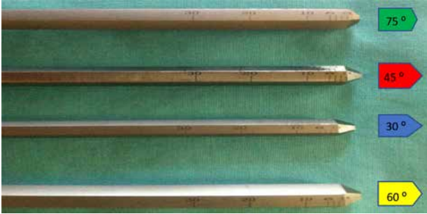
Şekil 7. Farklı açılardaki giriş uçlarına sahip delik açma aparatlarının görüntüsü. [1]
