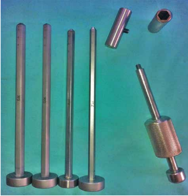
Şekil 6. Farklı kalınlıklardaki delik açma aparatlarının görüntüsü. [1]
