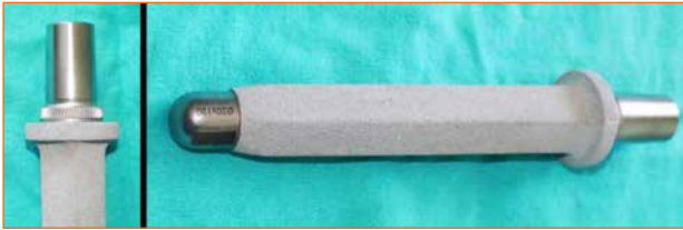
Şekil 4. Üretimi gerçekleştirilmiş bir protez sapında yakalıklar, yakalıkların üstündeki dişli ve konik bağlantı, yakalıkların altındaki eğimli yüzey ve hidroksiapatit (HA) kaplamaya ait detaylar görülmekte.
