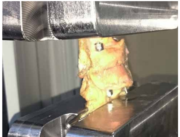
Şekil 5. Gergi bandı ve EFECE sistemleri ile tespit edilen kadavra patella transvers kırık simülasyonlarına artan distraksiyon kuvveti uygulandı.
